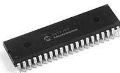
Figura 9 - Microcontrolador PIC18F4550
