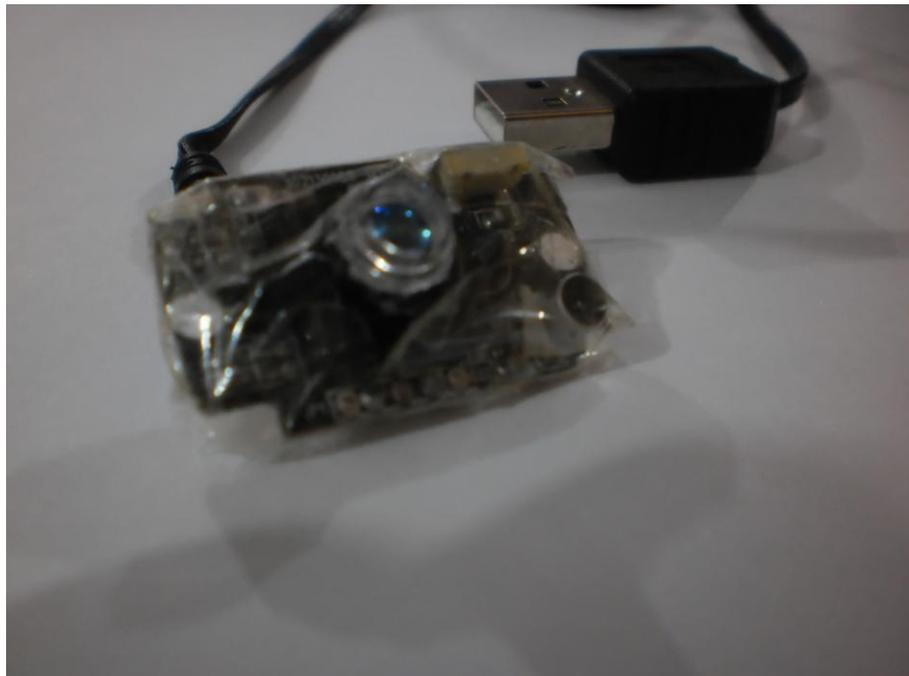
Figura 17 - Lente fixada sobre a webcam plastificada.
