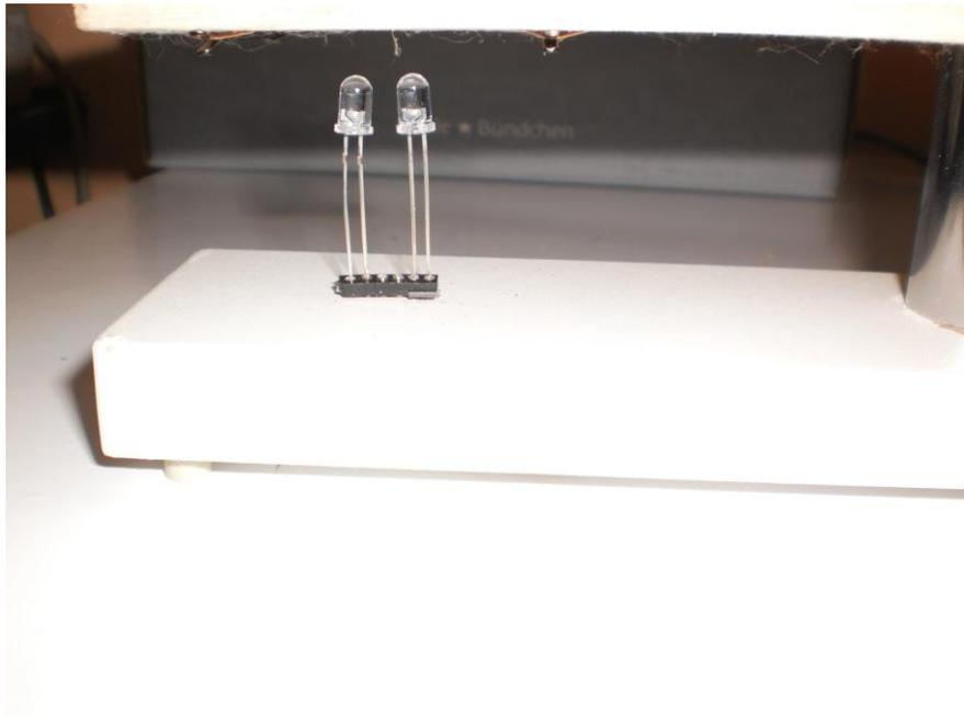
Figura 23 - LEDs Inferiores para transmissão de luz (base do microscópio)
